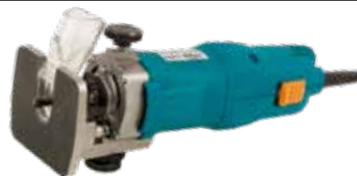
FRESADORA PERFILADORA FR192VG P.8 VIRUTEX 1.000 W, Ø fresa máx.: 25 mm, Ø pinza estándar: 8 mm. Velocidad en vacío: 14.000 - 30.000 /min. 1,8 kg. Perfilado de estratificados de todo tipo, pequeñas molduras, encajes de pernos y bisagras (con portaplantillas Virutex), repaso de galces en puertas o ventanas (usando para ello la fresa especificada). Sin más accesorios que los incluidos puede hacer regatas rectas o circulares.
