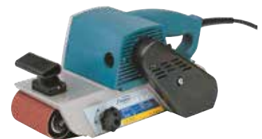
LIJADORA LB31E VIRUTEX Dispone de unos topes internos de carburo de tungsteno para evitar el deterioro de la carcasa por desplazamiento de la banda. Potencia: 1.200 W. Dimensiones banda: 690 x 100 mm. Superficie de lijado: 175 x 100 mm. Velocidad banda: 420 m / min. Peso: 6,5 kg.
